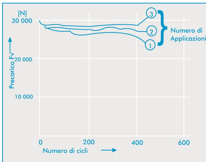
Questa registrazione dimostra che la perdita minima di precarico dovuta all'assestamento addirittura diminuisce a seguito dell'incrudimento delle superfici dei materiali di appoggio durante il riserraggio del fastener.
