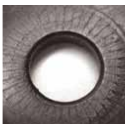
Superfici verniciate dopo l'utilizzo di NORD-LOCK con diametro esterno maggiore.
