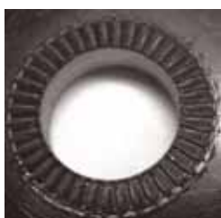
Superfici verniciate dopo l'utilizzo di NORD-LOCK con diametro esterno standard.
