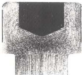
Un accurato controllo della profondità della cava consente maggiore presa alla chiave e permette una trasmissione di coppia più elevata senza slittamenti o danneggiamenti. Tutto ciò mantenendo inalterata la massima capacità di tenuta della testa.
